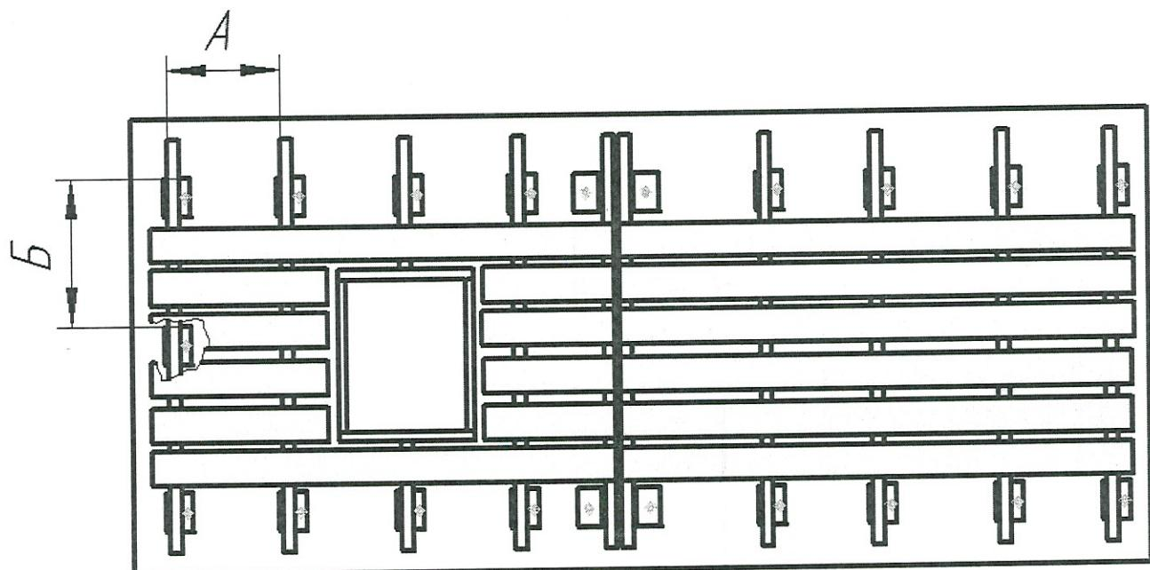
Шаг установки кронштейнов по горизонтали А рекомендуется выбирать в интервале от 350мм до 800мм, по вертикали Б - от 600мм до 1200мм.
